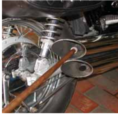
△ Die Abgasuntersuchung erfordert bei einigen Motorrädern besondere Maßnahmen, um die Messsonde an die richtige Stelle zu bringen.
