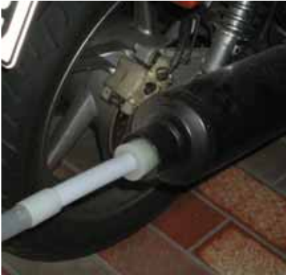
△ Die Abgasuntersuchung erfordert bei einigen Motorrädern besondere Maßnahmen, um die Messsonde an die richtige Stelle zu bringen.
