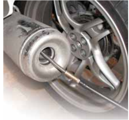
△ Die Abgasuntersuchung erfordert bei einigen Motorrädern besondere Maßnahmen, um die Messsonde an die richtige Stelle zu bringen.
